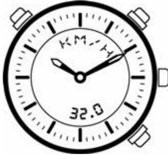
L'orologio calcola automaticamente la nuova velocità con il tempo misurato in precedenza mediante il cronometro e i nuovi parametri di distanza.
